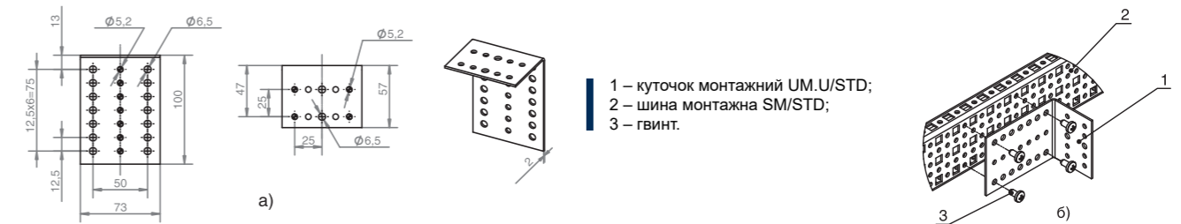
Рис. 3.20. Куточок монтажний UM.U/STD: а) розміри куточка; б) схема встановлення.
